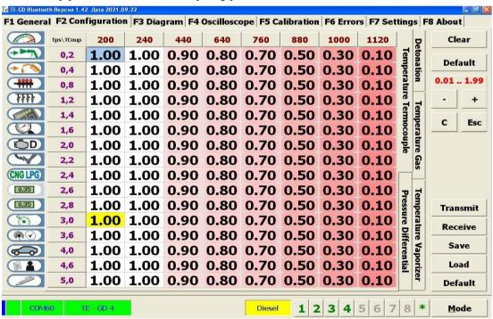
Эта таблица предназначена для защиты двигателя от максимальных температур.
