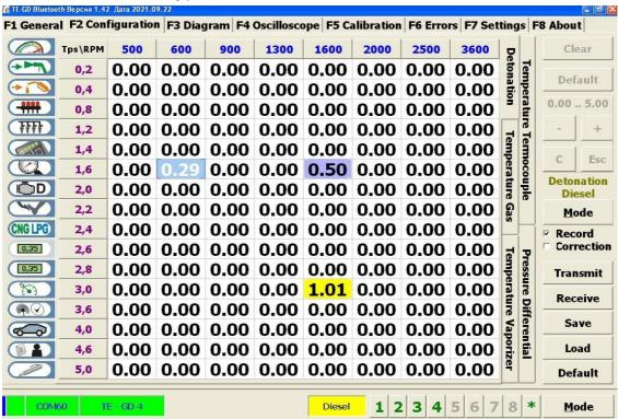
Значение фиксируется только по прошествии времени 10\*время фильтрации (дефалт 100мсек) и нахождении в одной ячейке таблицы. Т.е при равномерном движении.
