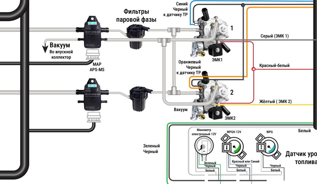
МОНТАЖНАЯ СХЕМА ALPHA MS-8-V8. 2 Редуктора
