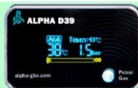
**Ожидание прогрева, режим работы автомат, индикация температуры перехода сменилась на индикацию оборотов перехода**
